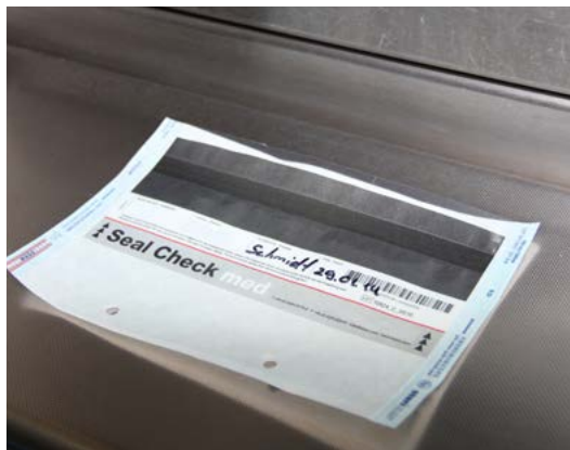
Seal-Check-Test: Beurteilung der Siegelnaht
