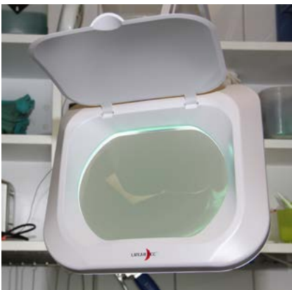
Lupenleuchte zur Inspektion der Medizinprodukte
