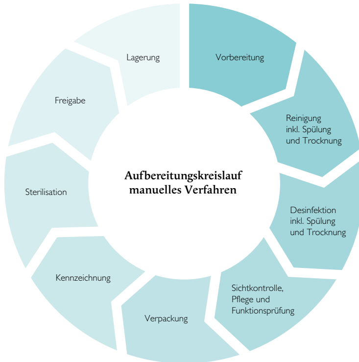
Abbildung 3: Aufbereitungskreislauf manuelles Verfahren
