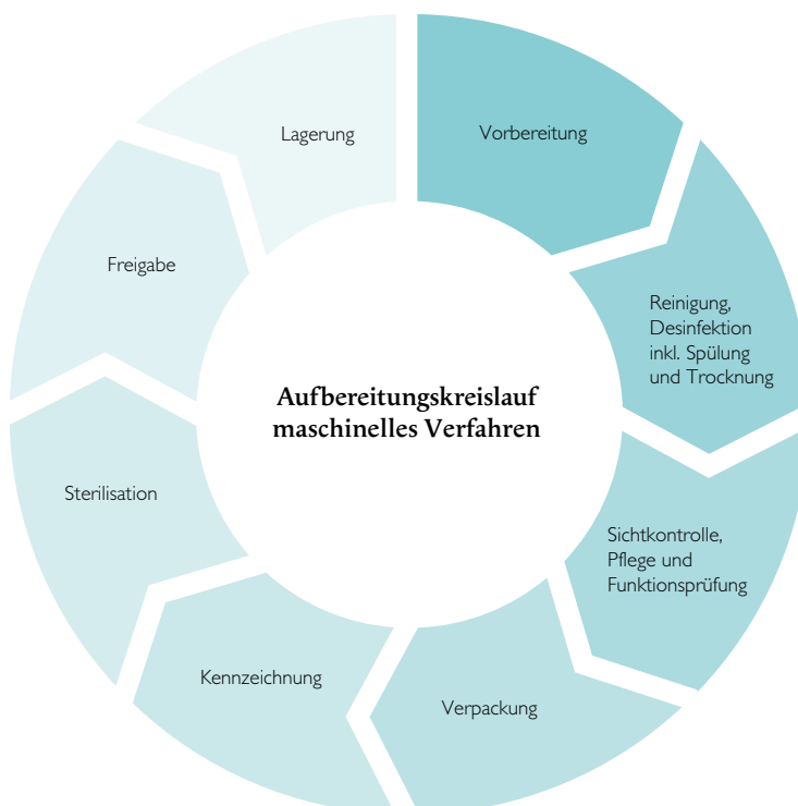
Abbildung 4: Aufbereitungskreislauf maschinelles Verfahren
